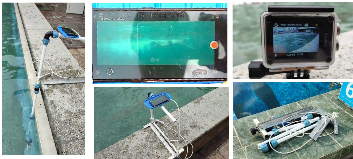
Foto. 1. Suport mobil pentru efectuarea înregistrărilor video subacvatice
