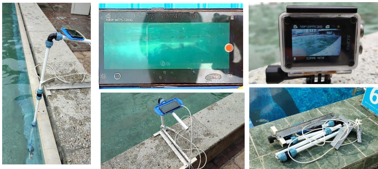
Foto. 1. Suport mobil pentru efectuarea înregistrărilor video subacvatice
